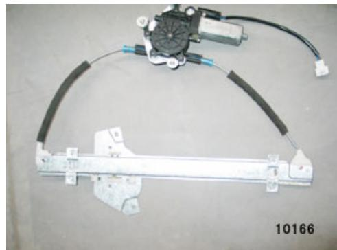
装配要求：固定螺栓或螺母，扭矩为  $M=7 \pm 1 \text{ N} \cdot \text{m}$ ；安装且调整完之后，需要保证玻璃能平稳、顺利的上升和下降，不允许玻璃有晃动、振颤、冲击等现象；电动要求：上升/下降时间为 $\leq 5\text{S}$ 。
