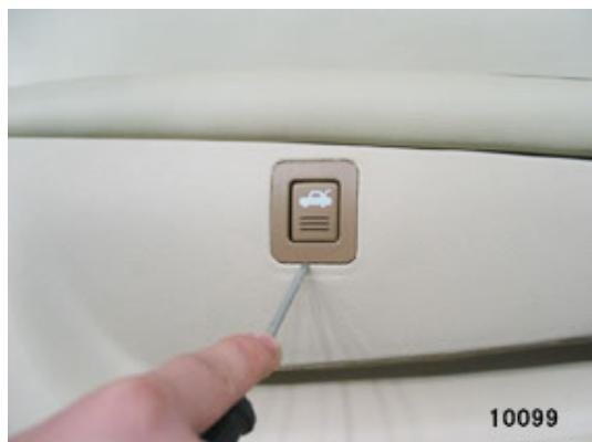
2、用螺丝刀向外撬起电动尾箱开关并拆下螺栓；
