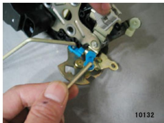
3、松开车门锁上的三颗固定螺栓取出门锁。
