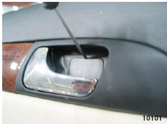
3、用螺丝刀向外撬起内拉手上的螺栓装饰件；
