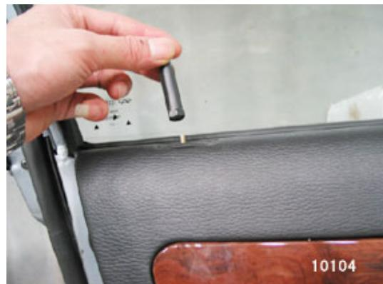
6、拆下门饰板上的五个固定螺栓；
